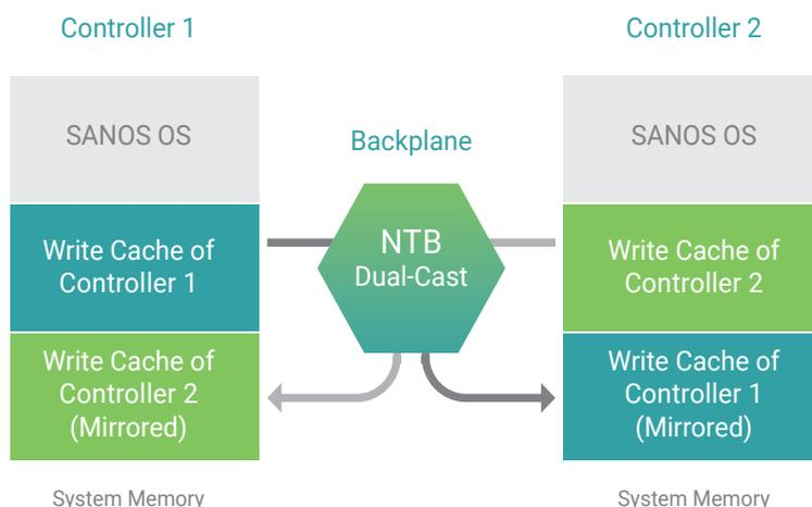
Схема зеркалирования кэша
