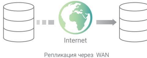
QReplica 2.0 использует iSCSI соединения для механизма репликации. Можно использовать всю пропускную способность сетевого порта для достижения оптимальной скорости копирования. Однако, если требуется зарезервировать часть пропускной способности для других задач, скорость репликации можно ограничить при помощи Traffic Shaping.
